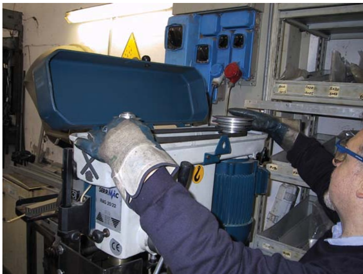
Figura 3 – Cambio della velocità di rotazione del mandrino
