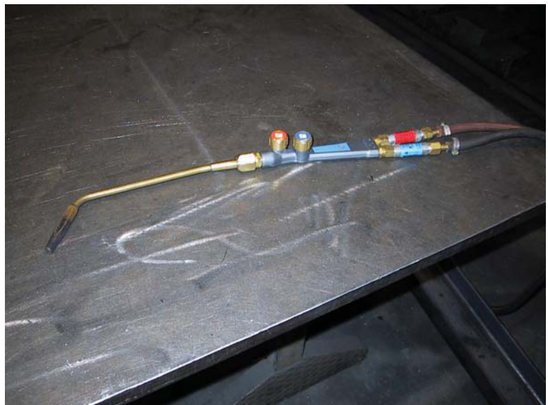
Figura 7 – Cannello da saldatura con i rubinetti di acetilene (rosso) e di ossigeno (blu)
