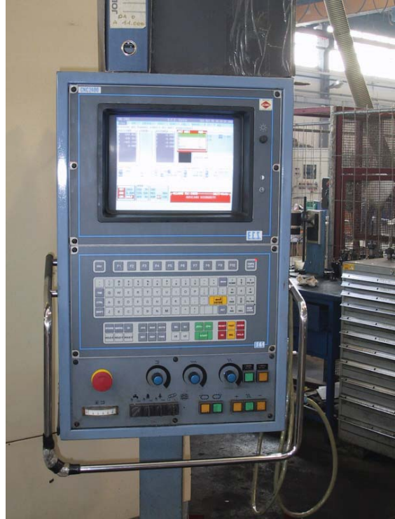
Figura 2 – Quadro di programmazione centro di lavoro
