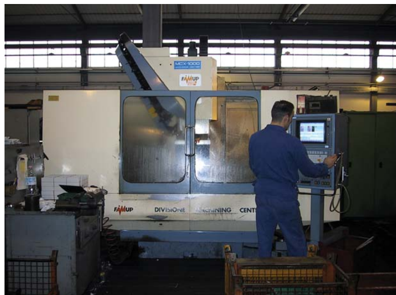
Figura 3 – Centro di lavoro in funzione
