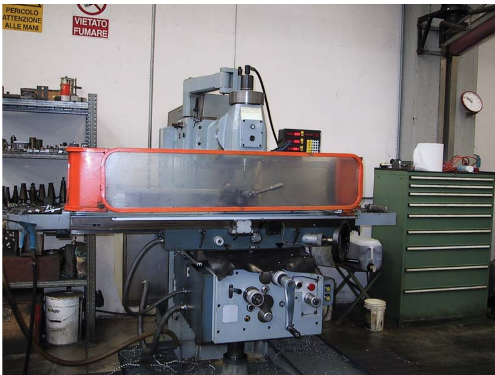
Figura 1 – Fresatrice dotata di riparo mobile con dispositivo di blocco
