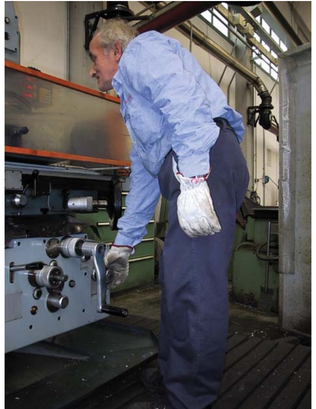
Figura 3 – Inserimento della frizione per la messa in rotazione del mandrino
