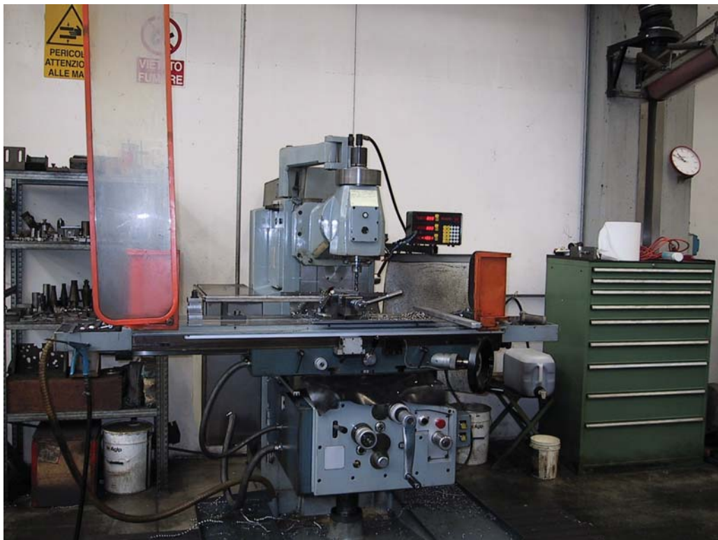
Figura 2 – Macchina con riparo mobile aperto
